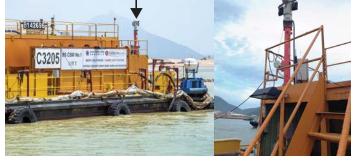
在工程船上安裝的閉路電視監察系統 CCTV installed on work barge
