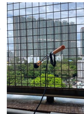
噪音水平监测站 (NM4)
