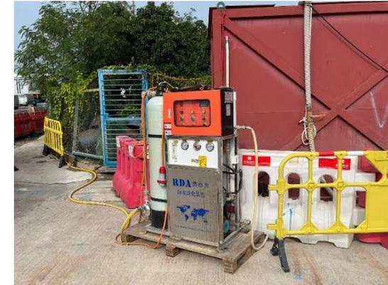
利用海水淡化裝置，用淡化的水來噴灑地面，防止塵土飛揚
