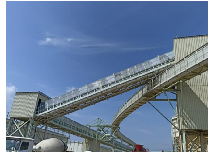
使用全密封式的输送带，防止尘土飞扬
