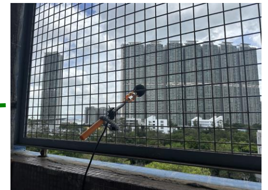
噪音水平监测站 NM4
