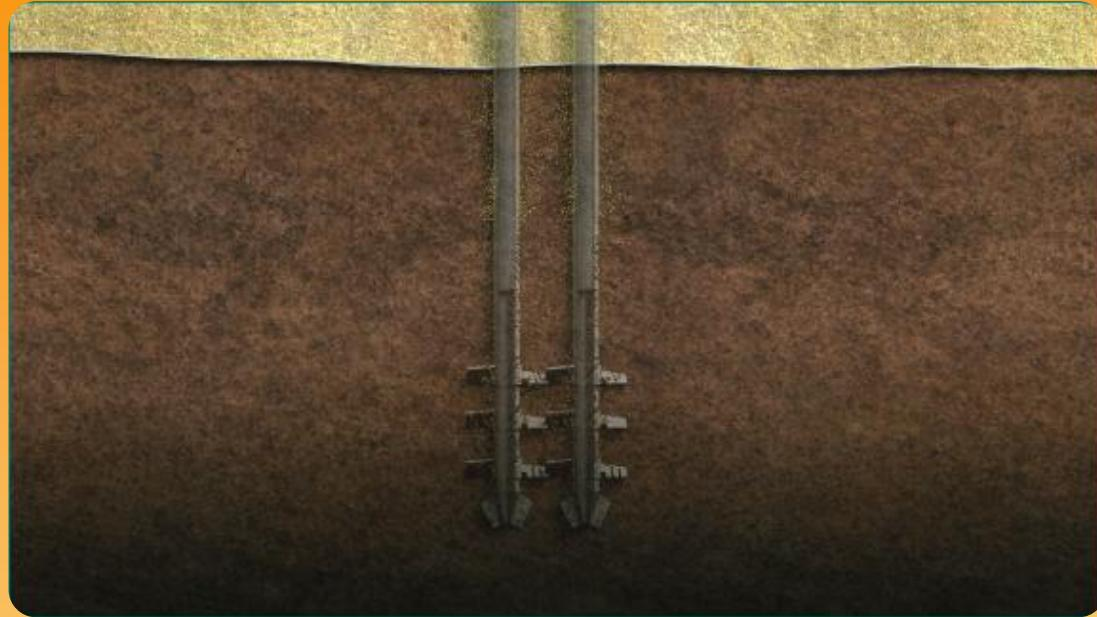
1. 先铺上约两米厚沙层。铺好沙层后，钻机钻入海床至设定深度
