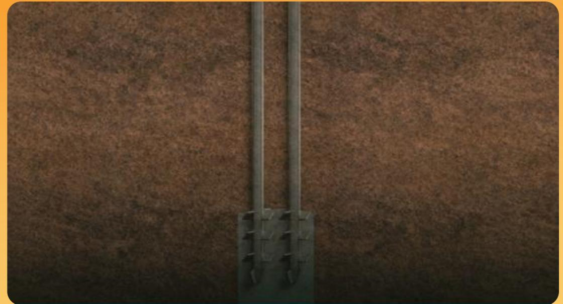
2. 当到达设定深度时，便开始注入水泥并混合污泥坑内的软泥，同时拔起钻机至海床表面
