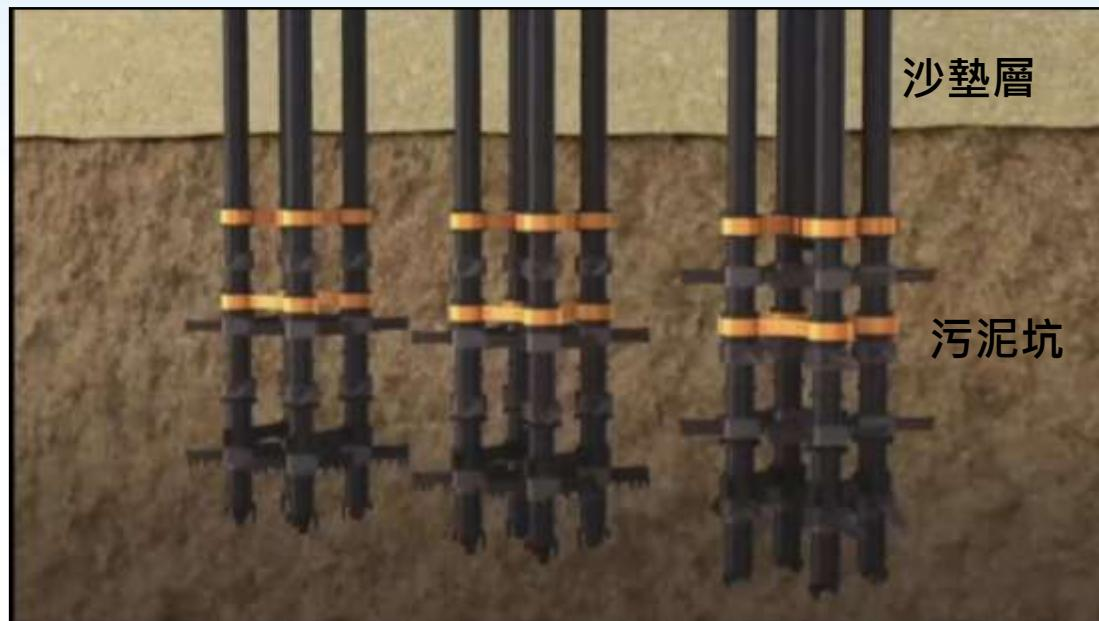
步驟一：鋪上約兩米厚沙墊層後，深層水泥拌合鑽機鑽入海床至設定深度
