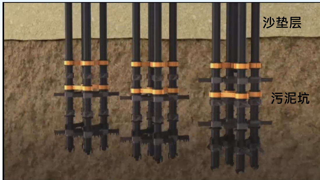
步骤一：铺上约两米厚沙垫层后，深层水泥拌合钻机钻入海床至设定深度
