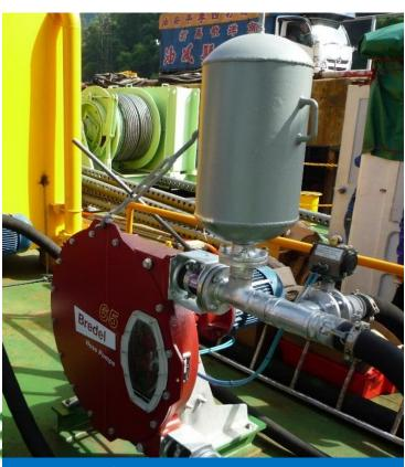
将水泥浆泵至深层水泥拌合用的 钻机
