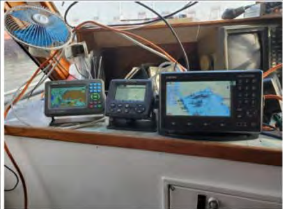
AIS 海圖機：(左) SUNHANG SH-598A / (中) FURUNO FA-170 / (右) SAMYUNG SI-70A
