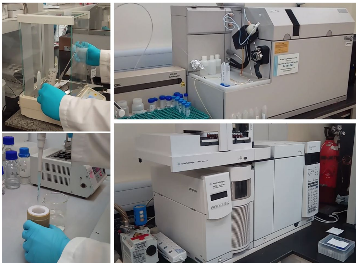
圖 2：皺瘤海鞘化驗樣本稱重和準備（圖左），利用電感耦合等離子體質譜儀（inductively coupled plasma-mass spectrometer；圖右上）和氣相色譜火焰離子化檢測器（gas chromatography-flame ionisation detector；圖右下）分別檢測樣本中的硒含量和奧米加三含量。
