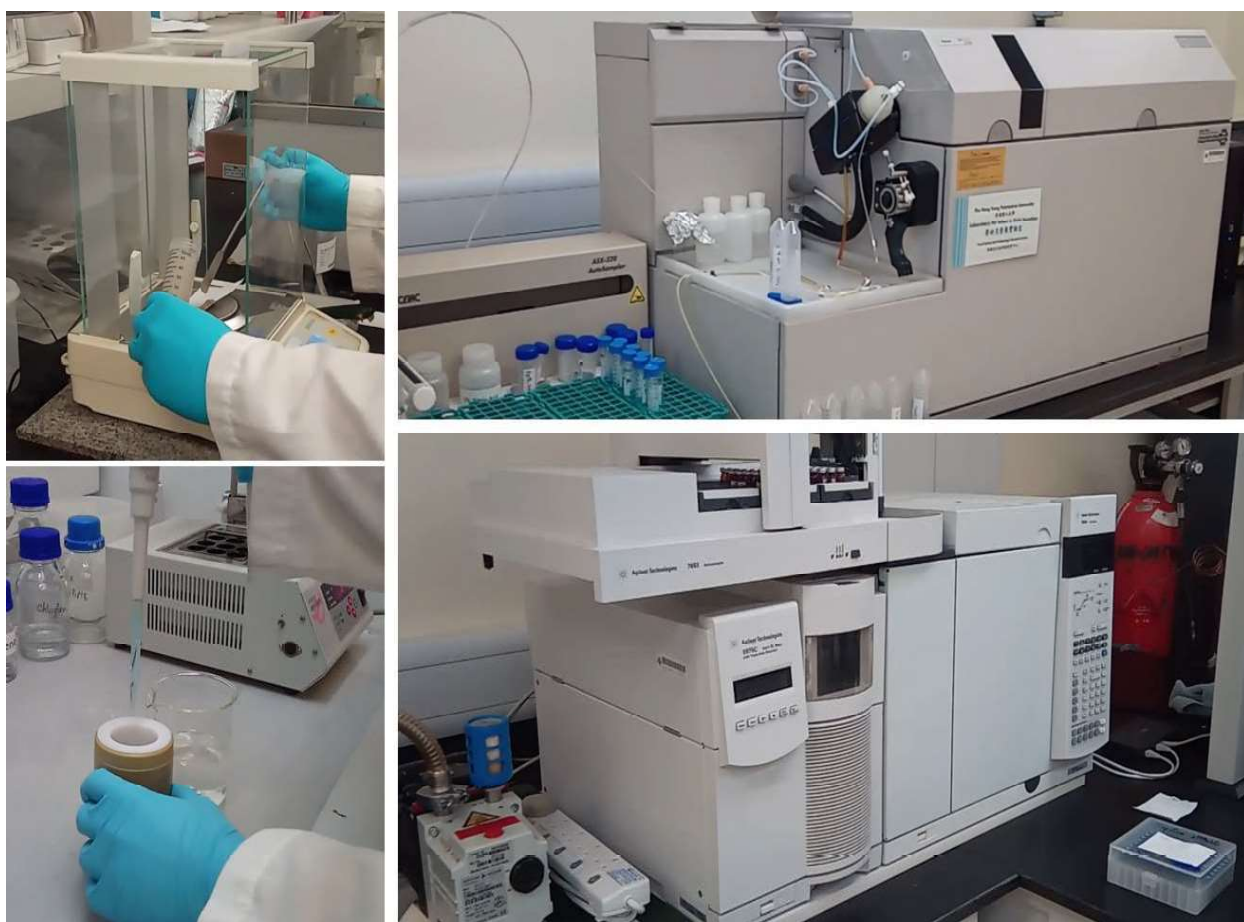
圖 2：皺瘤海鞘化驗樣本秤重和準備（圖左），利用電感耦合等離子體質譜儀（inductively coupled plasma-mass spectrometer；圖右上）和氣相色譜火焰離子化檢測器（gas chromatography-flame ionisation detector；圖右下）分別檢測樣本中的硒含量和奧米加三含量。
