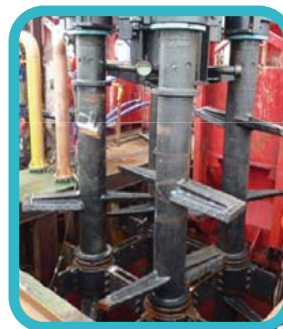
深層水泥拌合法鑽機 DCM Rigs
